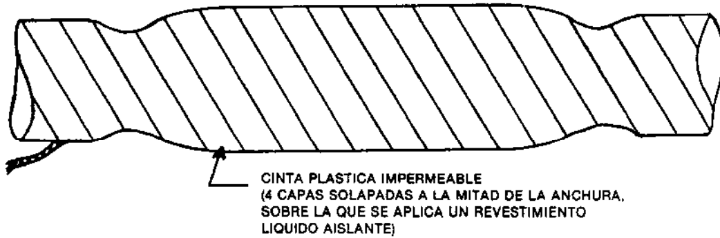
b) ENVOLVENTE EXTERIOR DEL EMPALME
