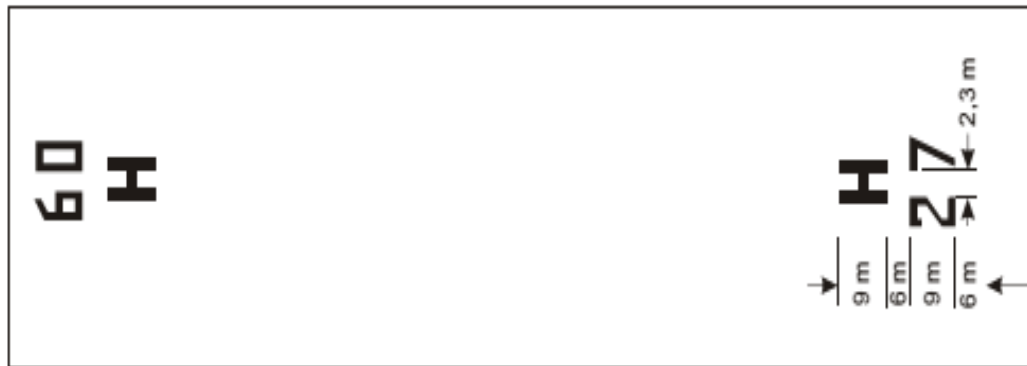
Figura 18A. Señal de designación de la FATO y señal de identificación de helipuerto para FATO de tipo pista de aterrizaje
